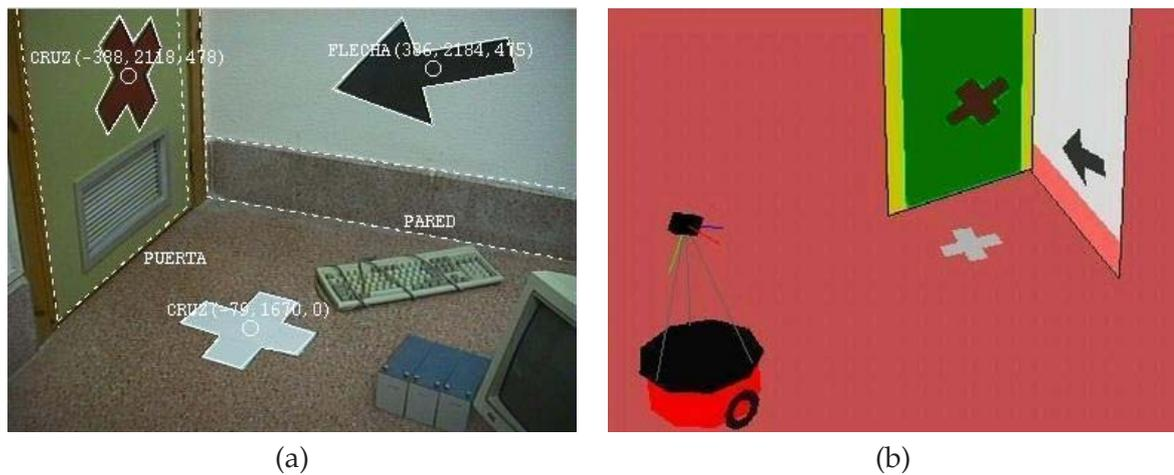
**Figura 4.6:** Ejemplo de interpretación planar de escenas: (a) Imagen original con la interpretación sobreimpresionada. Las señales aparecen etiquetadas con sus posiciones relativas al sistema  $S_{rob}$ , en mm. (b) Representación tridimensional interna asociada a la situación, con los elementos reconocidos debidamente posicionados y categorizados.
