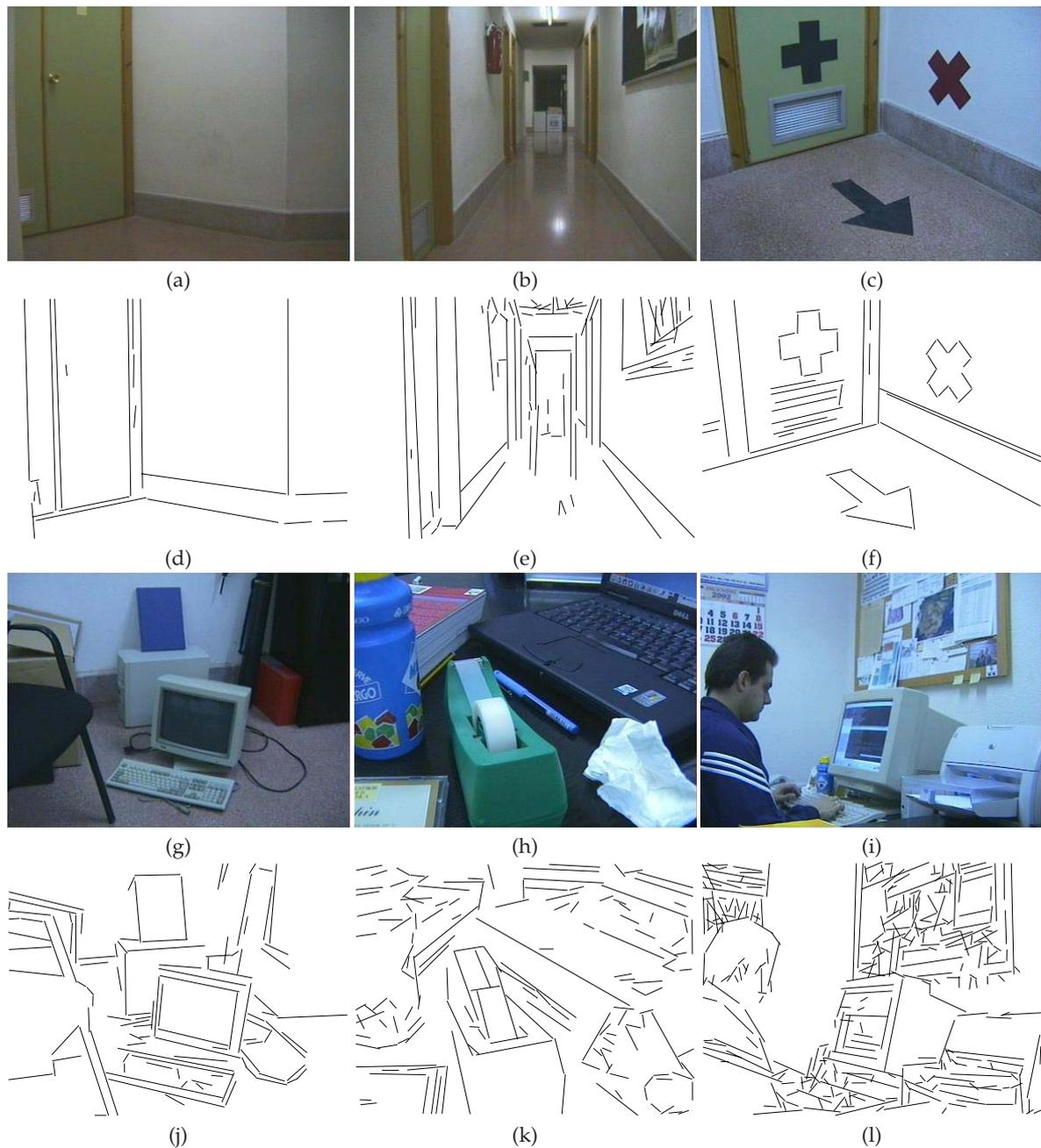
**Figura 2.8:** Ejemplos de operación del algoritmo (se muestra sólo la posición de los segmentos, sin incluir la información de color) (a-c,d-f) Imágenes típicas recogidas por el robot durante periodos de navegación, con los correspondientes conjuntos de segmentos extraídos. (g-i,l) Resultados obtenidos sobre escenas más complejas, con mayor cantidad de detalles.
